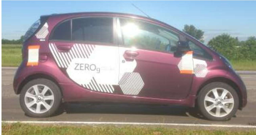
Figur 3. Citroen C1, ett av två elfordon inkluderade i EU-projektet FOREVER för undersökning av bulleremission. Det aktuella fordonet hade däck av dimension 175/55 R 15 på de drivande bakhjulen vid mättillfället.
