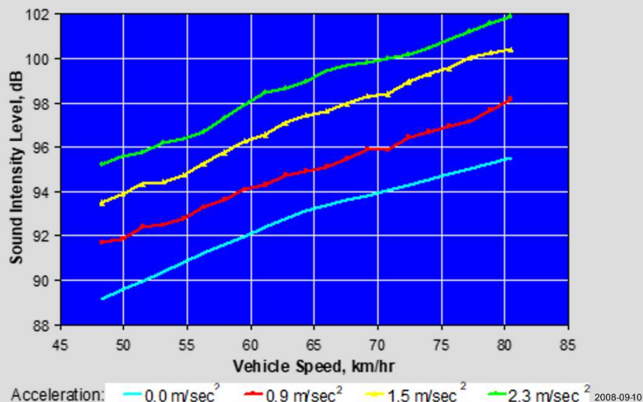
Figur 8. Exempel på bullernivåer från däck/vägbana beroende på hastighet och accelerationsnivåer. Med accelerationsnivån 2,3 m/sec 2 nås 50 km/t efter 6 sek från stillastående på en sträcka av 41 m. Bullernivån ökar med 6 dB under accelerationen som vid 50 km/t motsvarar bullernivån vid 80 km/t konstant fart. Exemplet har jag hämtat från ett kursprogram, diagrammet kommer ursprungligen från Porsche via Ulf Sandberg, VTI.
